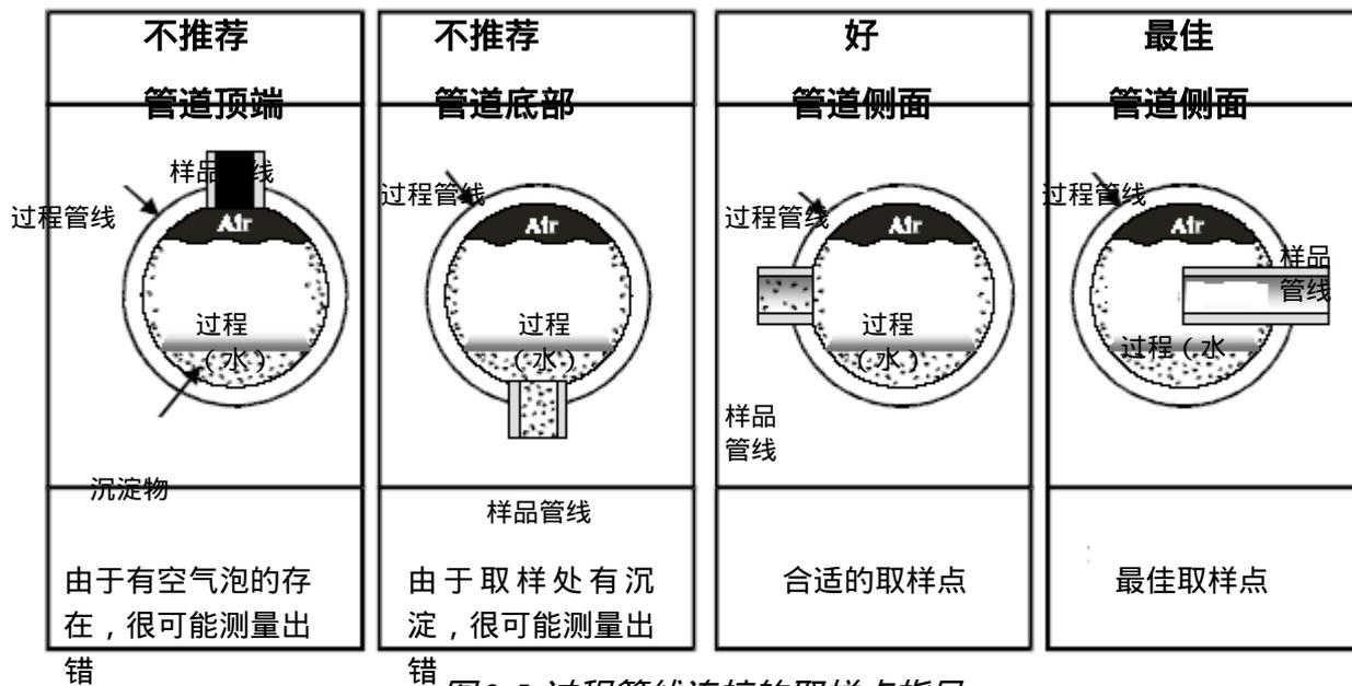
图 2-5 过程管线连接的取样点指导
