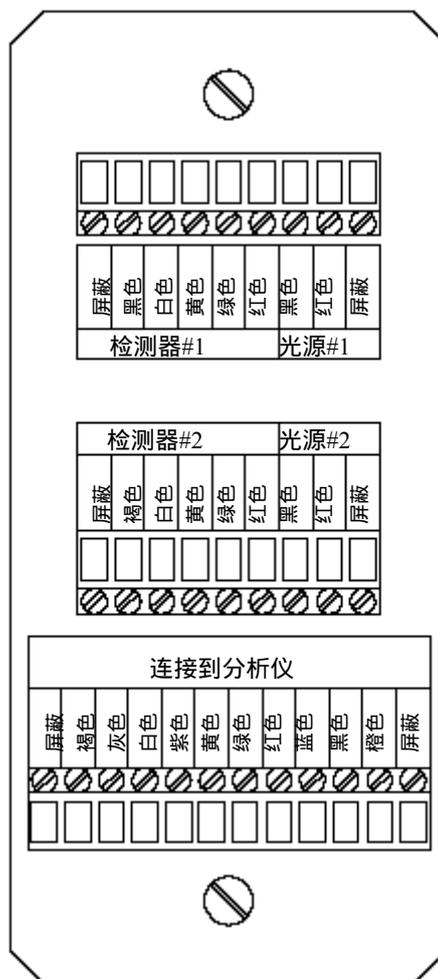
图 4-3 浊度传感器接线端排列
