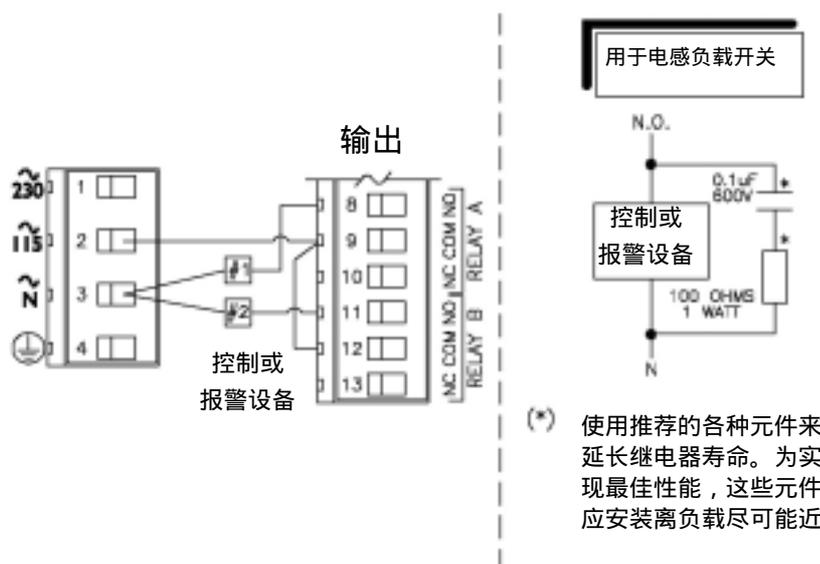
图2-12 连接控制/报警设备到继电器上
