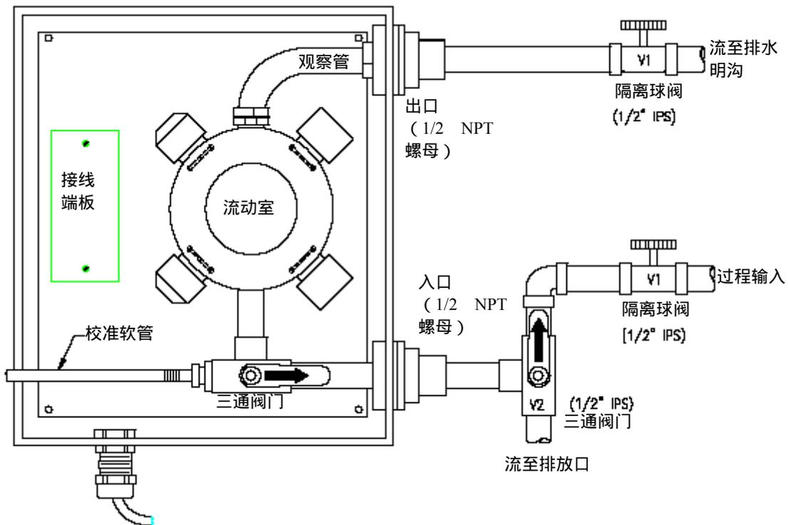
图2-2 推荐样品迂回线传感器管道布置
