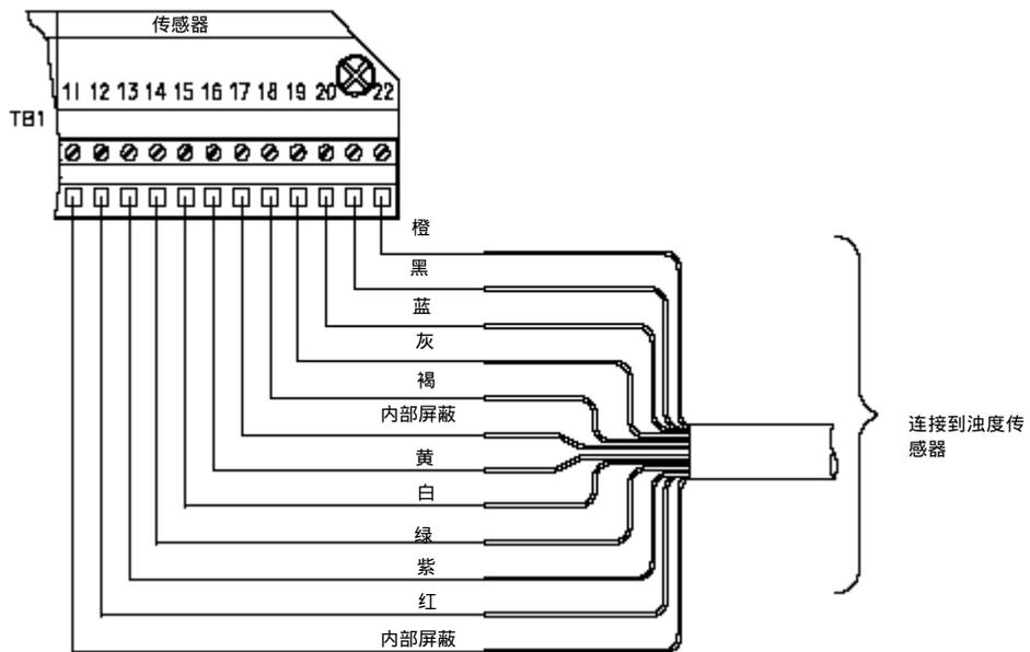
图 2-11 连接 8320 型低浊度传感器和序列号无字母前缀的分析仪
