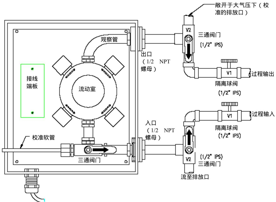
图 2-1 推荐闭合回路传感器管道线布置
