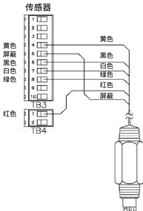
图 2-5 连接 GLI 5 线差分法传感器
