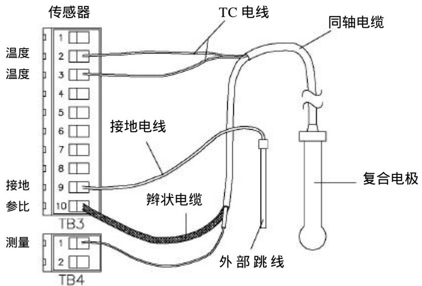
图 2-7 连接带接地棒的常规复合电极
