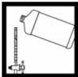
1. 采用滴定管滴定时，首先向25mL滴定管中加入试剂3。
