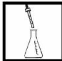
4. 使用带有刻度的滴管，加入1毫升试剂1，摇晃混合。
