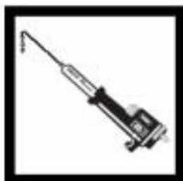
3. 旋转移液按钮，向滴定仪中注入几滴试剂3。将计数器重置为0。
