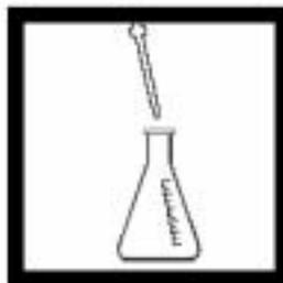
3. 使用移液管按照表11所列样品体积将样品移至250mL锥形瓶中。
