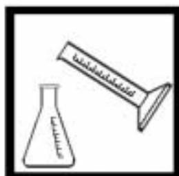
5. 用量筒量取8毫升试剂2加入锥形烧瓶中，摇晃混合。
