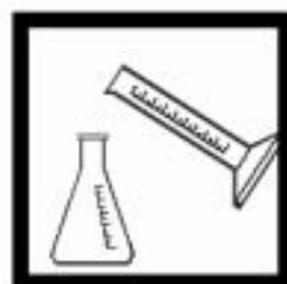
6. 用量筒量取8mL试剂2加入锥形瓶。摇晃混匀。
