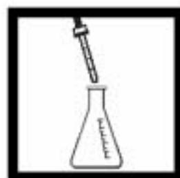
5. 使用有刻度的滴管加入1mL试剂1。摇晃混匀。
