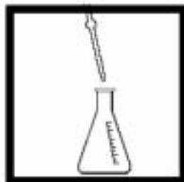
2. 用移液管移取20.00毫升标样2溶液，加入一个洁净的250-毫升锥形烧瓶中。
