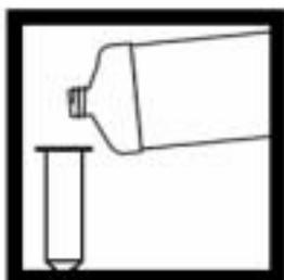
1. 如果使用数字式滴定仪，请将试剂3溶液装入洁净的滴定筒中。
