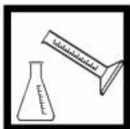
8. 用量筒量取8mL试剂2加入锥形瓶。摇晃混匀。
